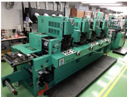
SANKI製 4色刷り回転式印刷機
