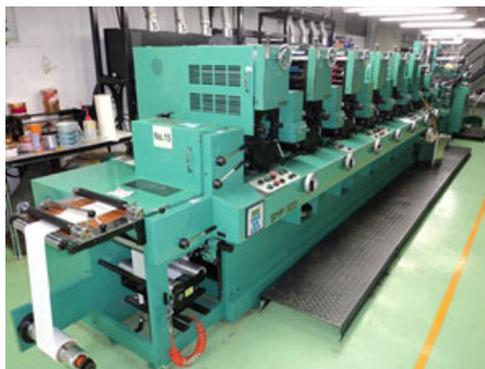
SANKI製 6色刷り回転式印刷機
